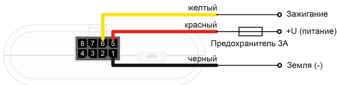
Рис. 3.4. Подключение электропитания к терминалу
